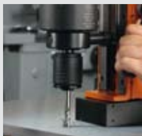
Gwintowanie za pomocą aparatu gwintującego
