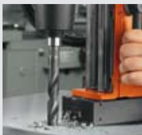
Wiercenie wiertłem krętym z uchwytem wiertarskim lub oprawką stożkową MK 3
