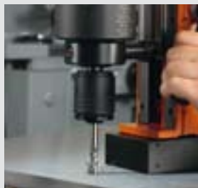
Gwintowanie za pomocą aparatu gwintującego
