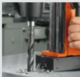
Wiercenie wiertłem krętym z uchwytem wiertarskim lub stożkowym MK 3
