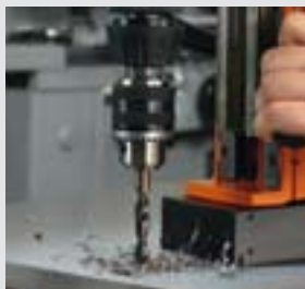
Wiercenie wiertłem krętym z uchwytem wiertarskim
