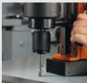
Gwintowanie za pomocą aparatu gwintującego
