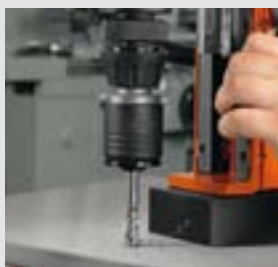
Gwintowanie za pomocą szybkowymiennej uchwyty do gwintowania
