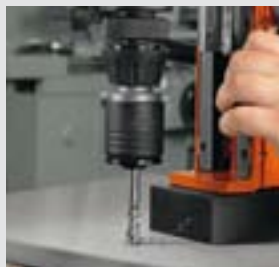
Gwintowanie za pomocą szybkowymennego uchwyty do gwintowania
