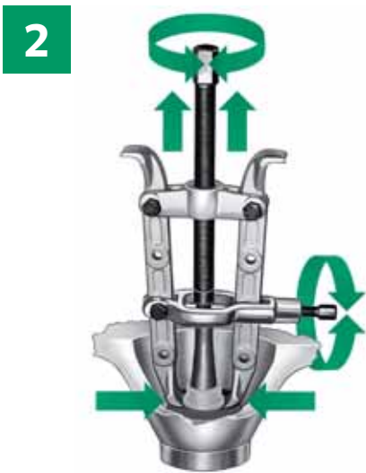
2 Zasada działania ściągacza dwuramiennego
